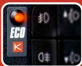
Con il led acceso, la potenza del motore è in modalità ridotta.
